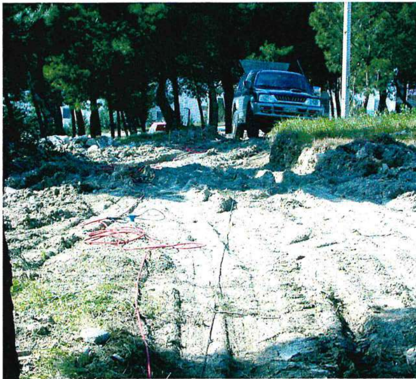
Foto n. 22 stendimento sismico n.1
