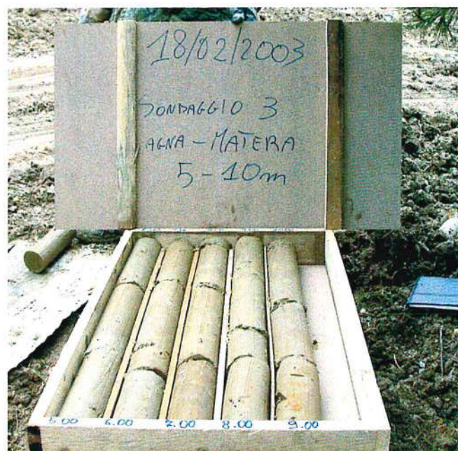
Foto n.13 – sondaggio n.3 da 5 a 10 metri
