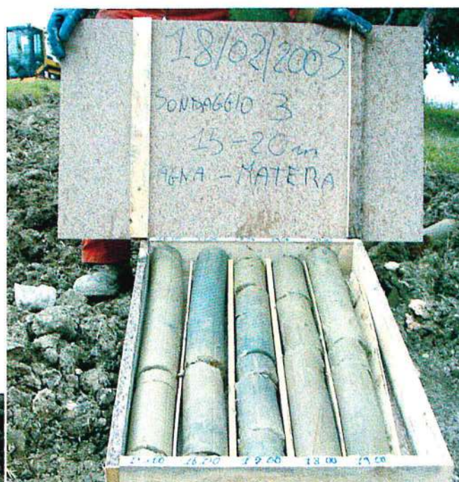
Foto n.15 – sondaggio n.3 da 15 a 20 metri
