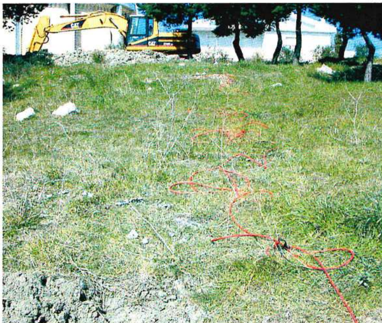
Foto n. 24 stendimento sismico n.3
